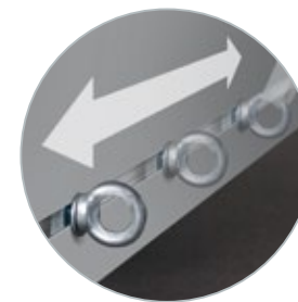
Geïntegreerde bindrail in laadruimte
