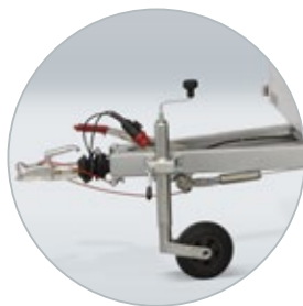
V-dissel uit U-profiel bij breedte 126 cm
